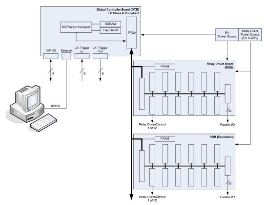
FIGURE 5-1: FUNCTIONAL BLOCK DIAGRAM
